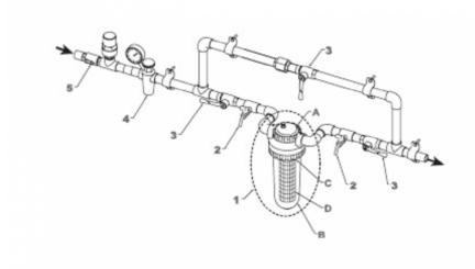
1. Filtro A) Testa B) Vaso C) Ghiera D) Cartuccia 2. Rubinetto test acqua 3. Rubinetto intercettazione 4. Riduttore di pressione 5. Valvola di ritegno
